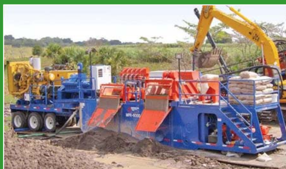
Impianto Miscelazione, Ricircolo e Pompaggio MPR 6000 da 2000 litri/min
